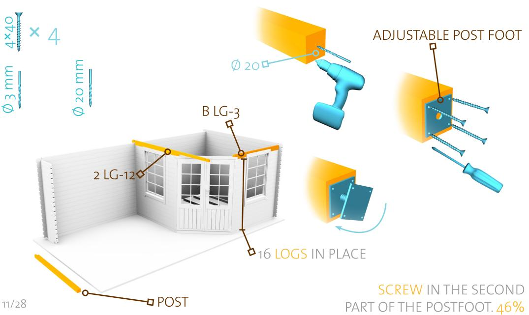
ATTACH THE **POSTS** TO THE WALL WITH SCREWS. MAKE SURE THAT THEY **ARE** STRAIGHT.
